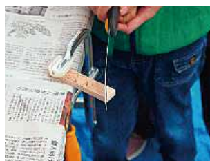
写真2 クランプで押さえ鋸で切る
