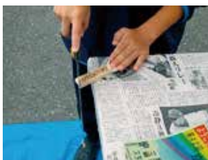
写真4 手で押さえ鋸で切る
